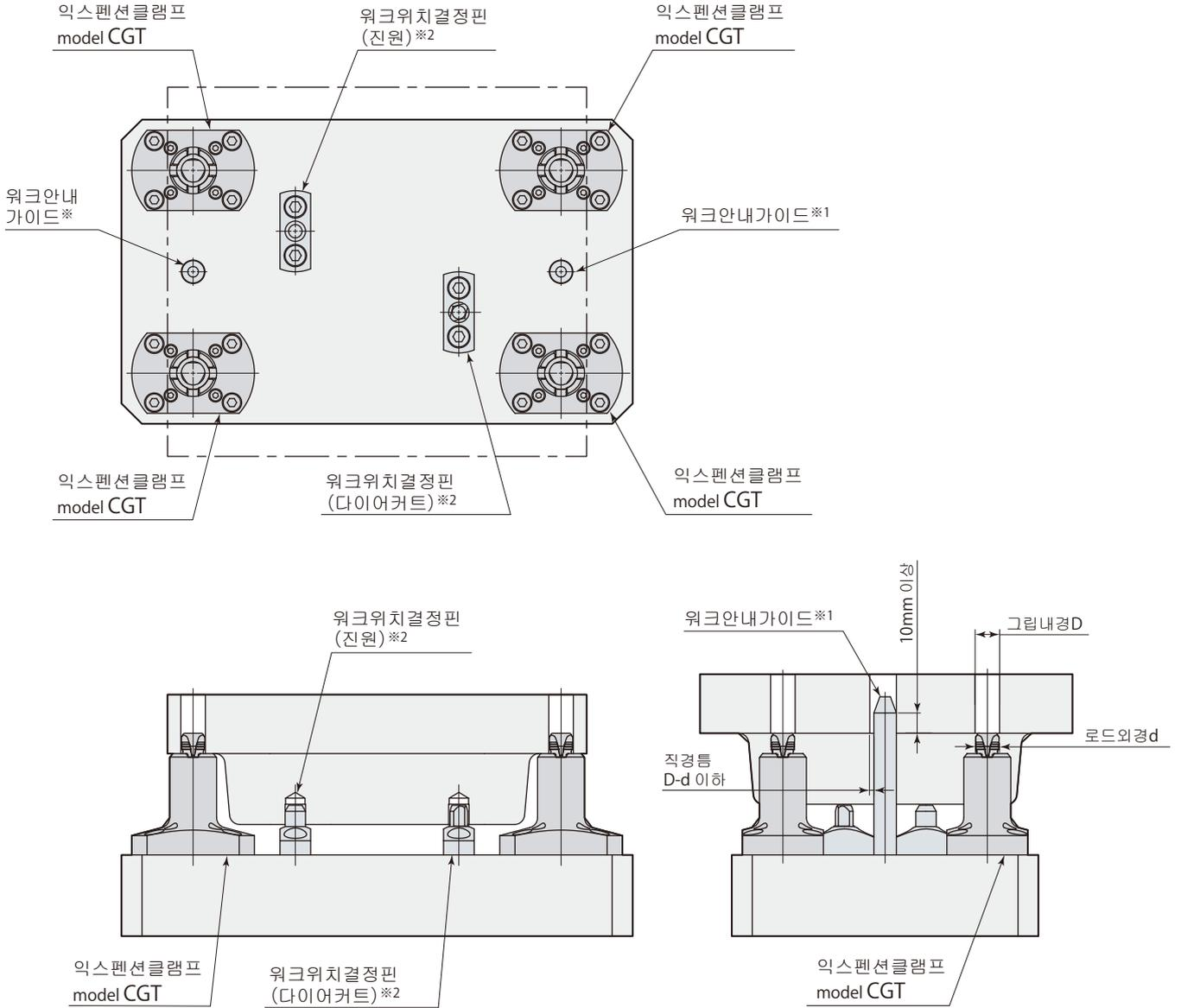
※1: 자동반송장치나 로봇 반송에 의한 충격 등으로 클램프부가 파손되는 것을 방지하기 위하여, 워크안내가이드를 설치해 주십시오. 워크안내가이드는, 위의 그림을 참고로, 흡위치정도를 고려해서 선정해 주십시오.
