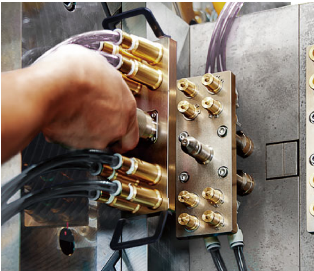
1,800kN 注塑机 多路连接器MCC Rc1/4 8接口×2组 实施例
