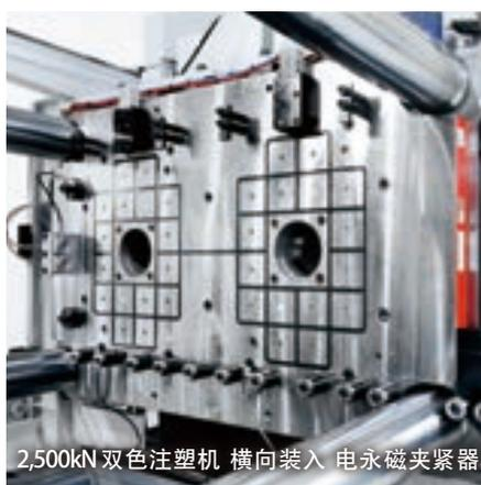
2,500kN 双色注塑机 横向装入 电永磁夹紧器
