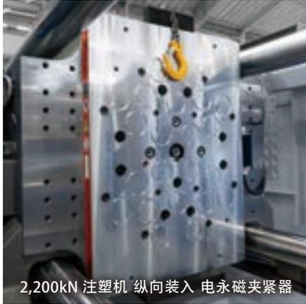
2,200kN 注塑机 纵向装入 电永磁夹紧器
