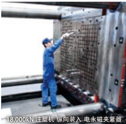
18,000kN 注塑机 纵向装入 电永磁夹紧器
