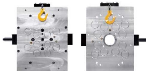
可動盤 / 固定盤 クランププレート
