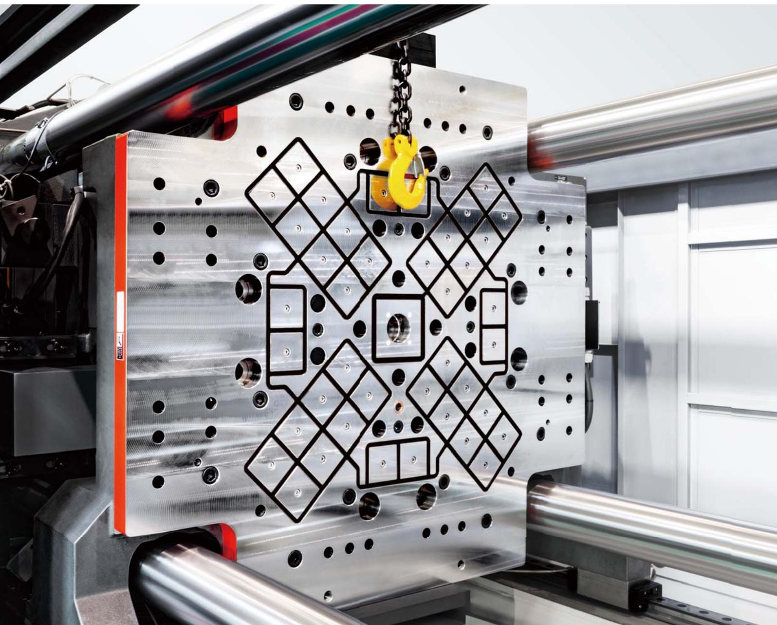
スクエア コア マグクランプ プレート厚さ35mmモデル 型締力 200 - 1,500 kN
