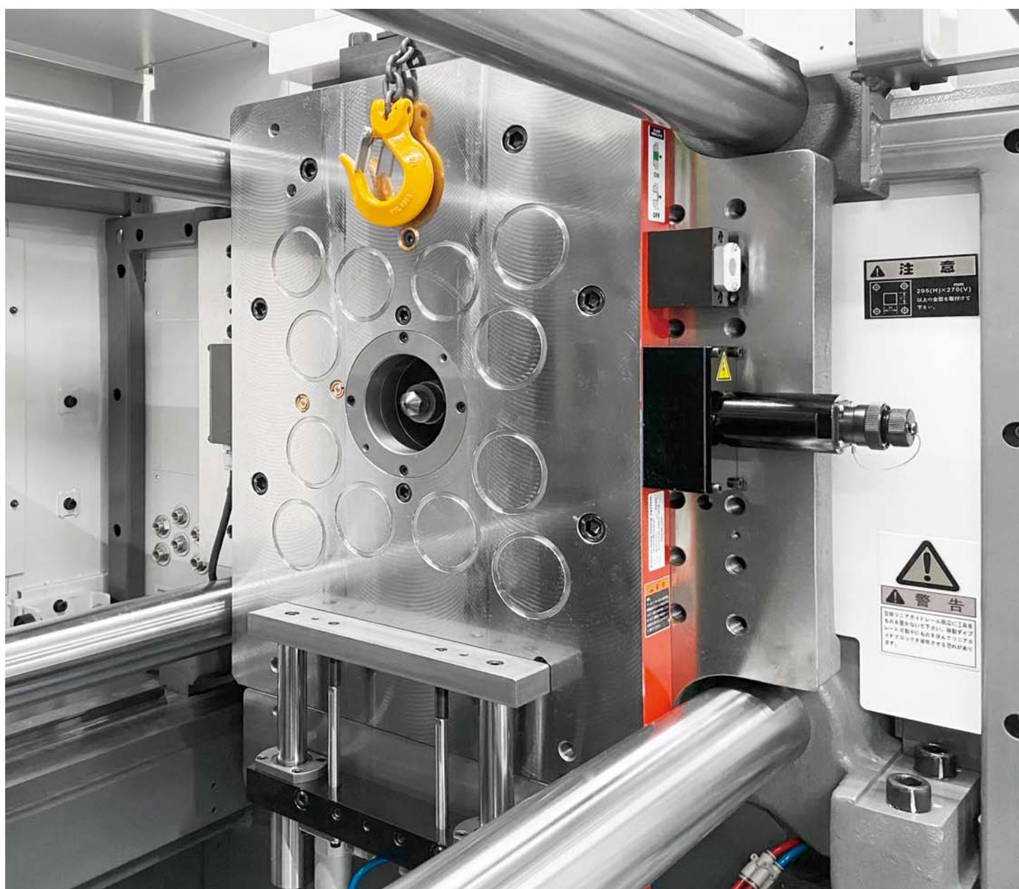
可動側 コア数 12 最大クランプ力 84 kN 固定側 コア数 12 最大クランプ力 84 kN
