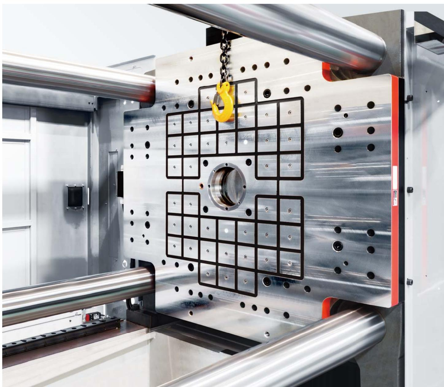
可動側 コア数 41 最大クランプ力 310 kN 固定側 コア数 40 最大クランプ力 314 kN
