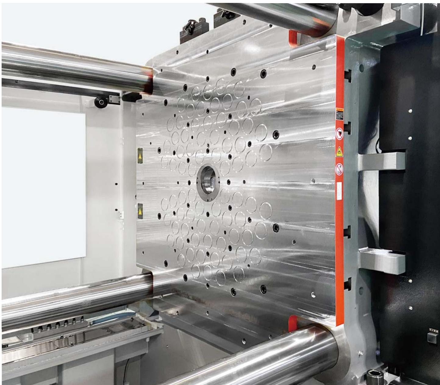
可動側 コア数 84 最大クランプ力 588 kN 固定側 コア数 76 最大クランプ力 532 kN
