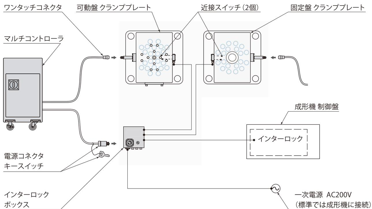
ワンタッチコネクタをクランププレートに接続し、固定盤／可動盤を個々に操作します。クランプ使用前に、電源を接続し、キースイッチを「段取」に切り替えてください。
