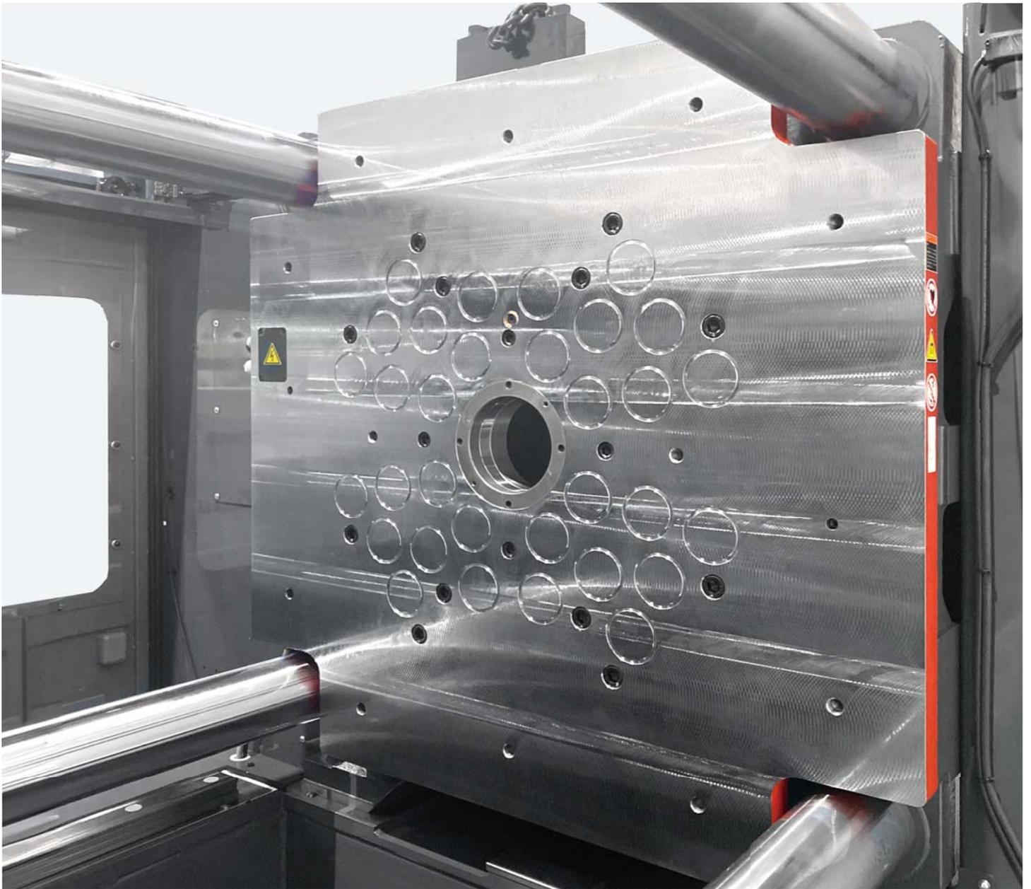
可動側 コア数 34 最大クランプ力 238 kN 固定側 コア数 32 最大クランプ力 224 kN
