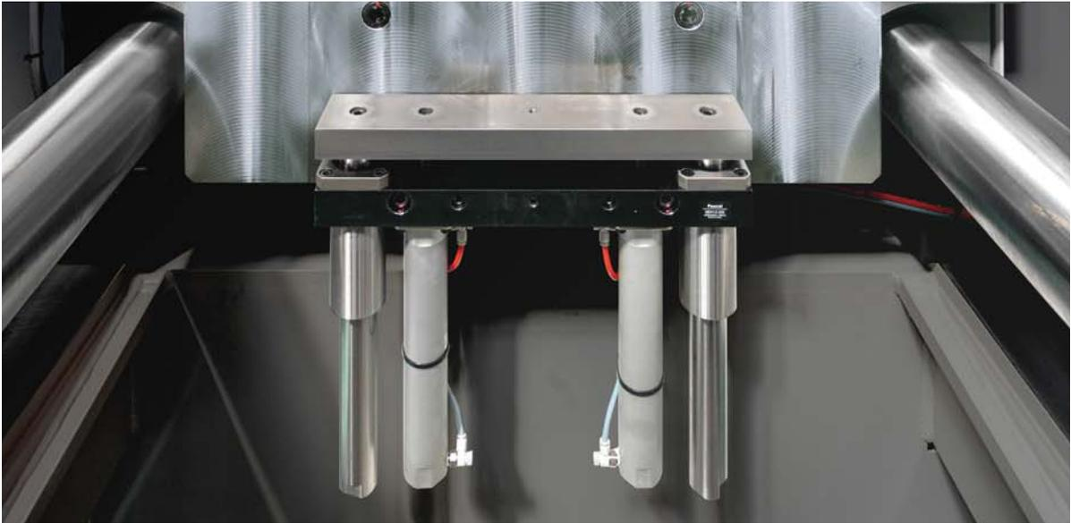
ロケートリングで金型をセンタリングし、その後ダイレベラーが金型を押しして水平出しを行ないます。
