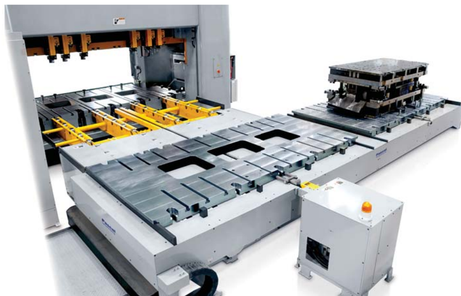
12,000kN プレス機械 金型交換装置
