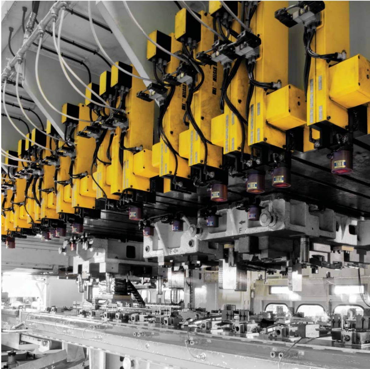
23,000kN トランスファープレス トラベリングクランプ
