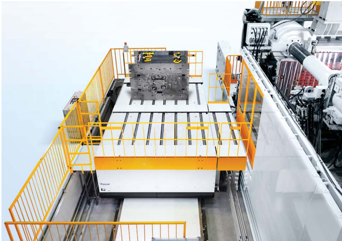
30,000kN 射出成形機 金型交換装置
