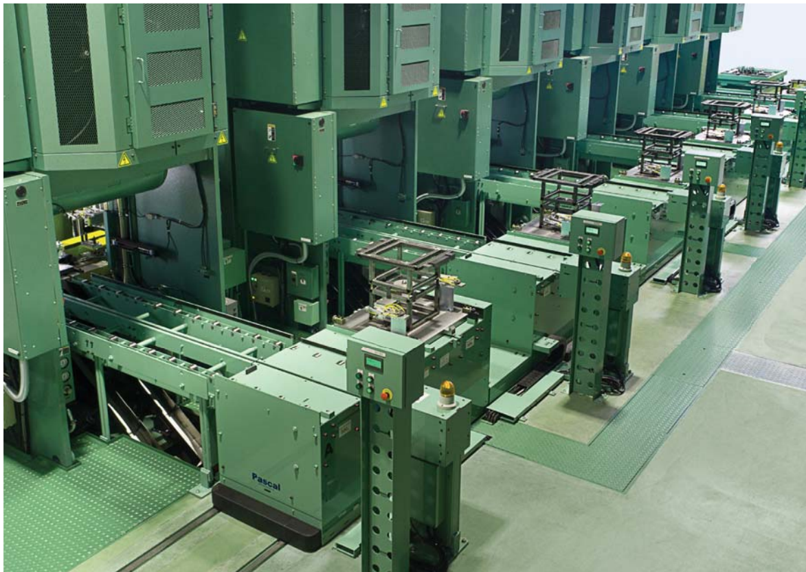
3,000kN プレス機械×6台タンデムライン 金型交換装置
