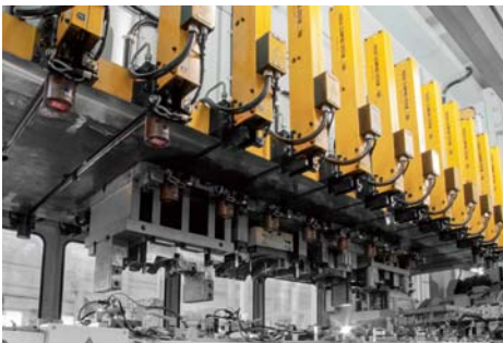
6,000kN(600tonf) Transfer press
