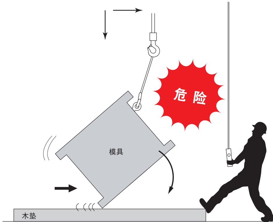
吊车要横向及纵向同时操作
