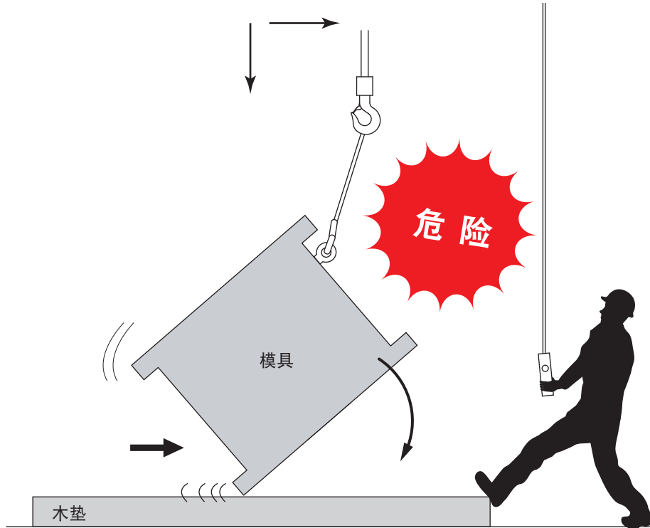
吊车要横向及纵向同时操作
