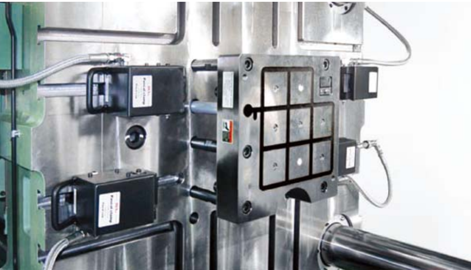
3,500kN(350ton)压铸机 C板电永磁夹紧器 & 油压夹紧器 TYB
