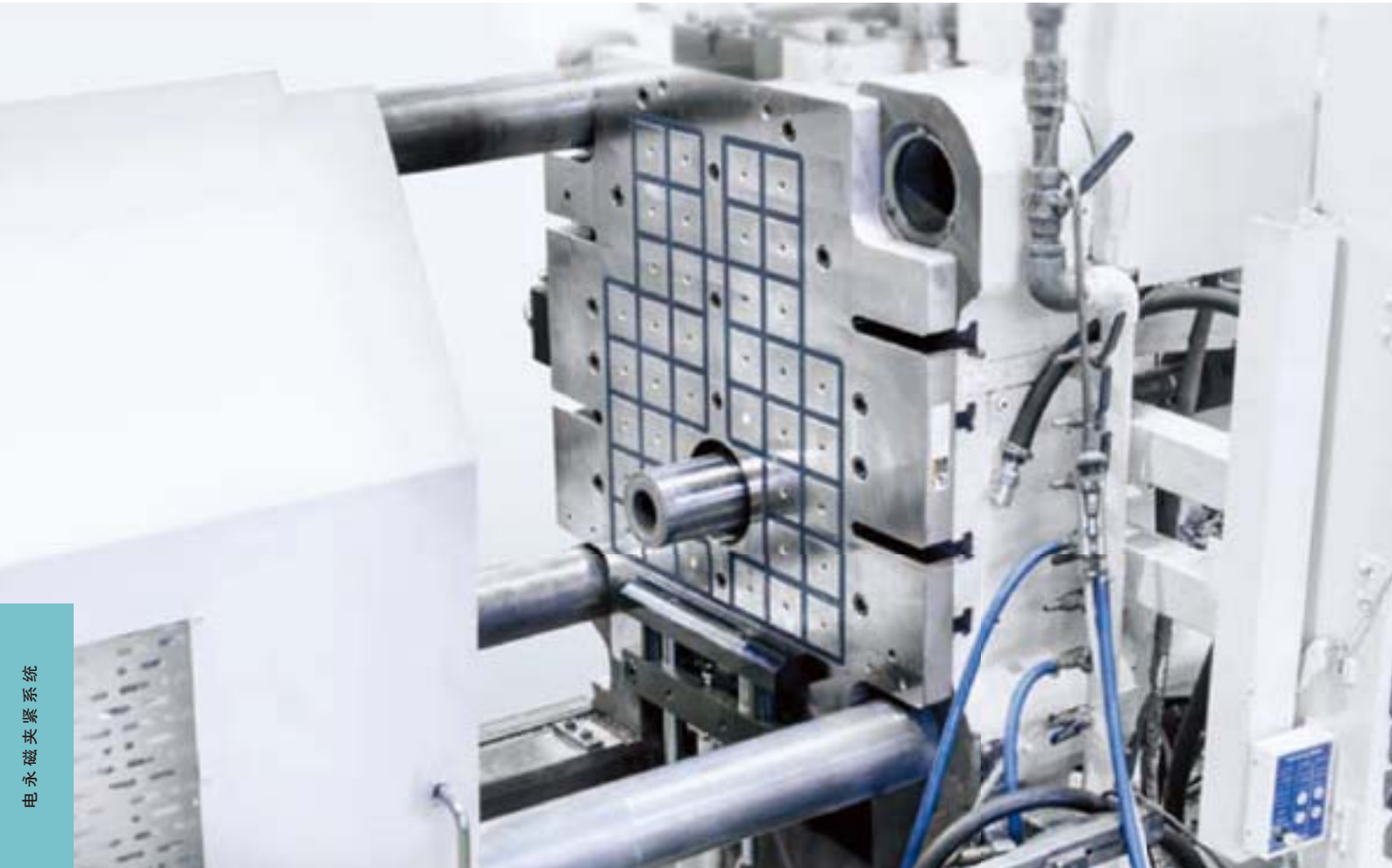
3,500kN (350ton) 压铸机 电永磁夹紧系统 & 模具定位装置
