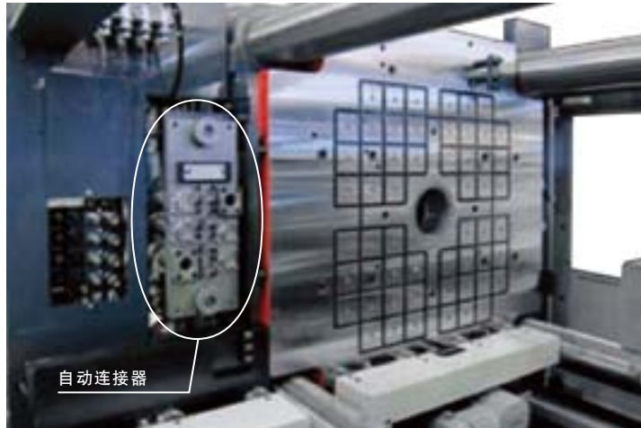
4,500kN (450ton) 注塑机 横向搬入 自动连接器 & 电永磁夹紧系统
