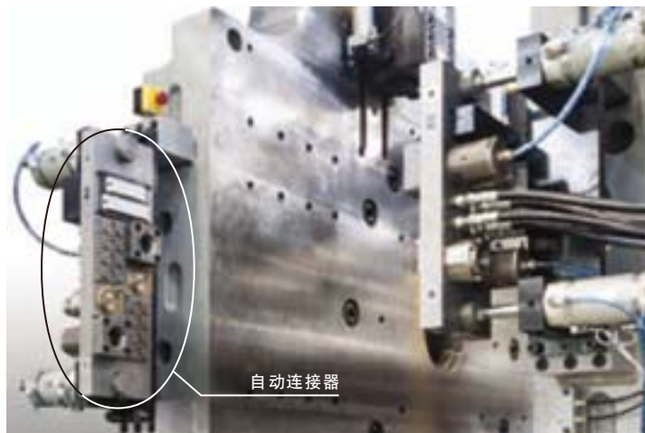
35,000kN (3,500ton) 注塑机 横向搬入 自动连接器 & 气动夹紧器
