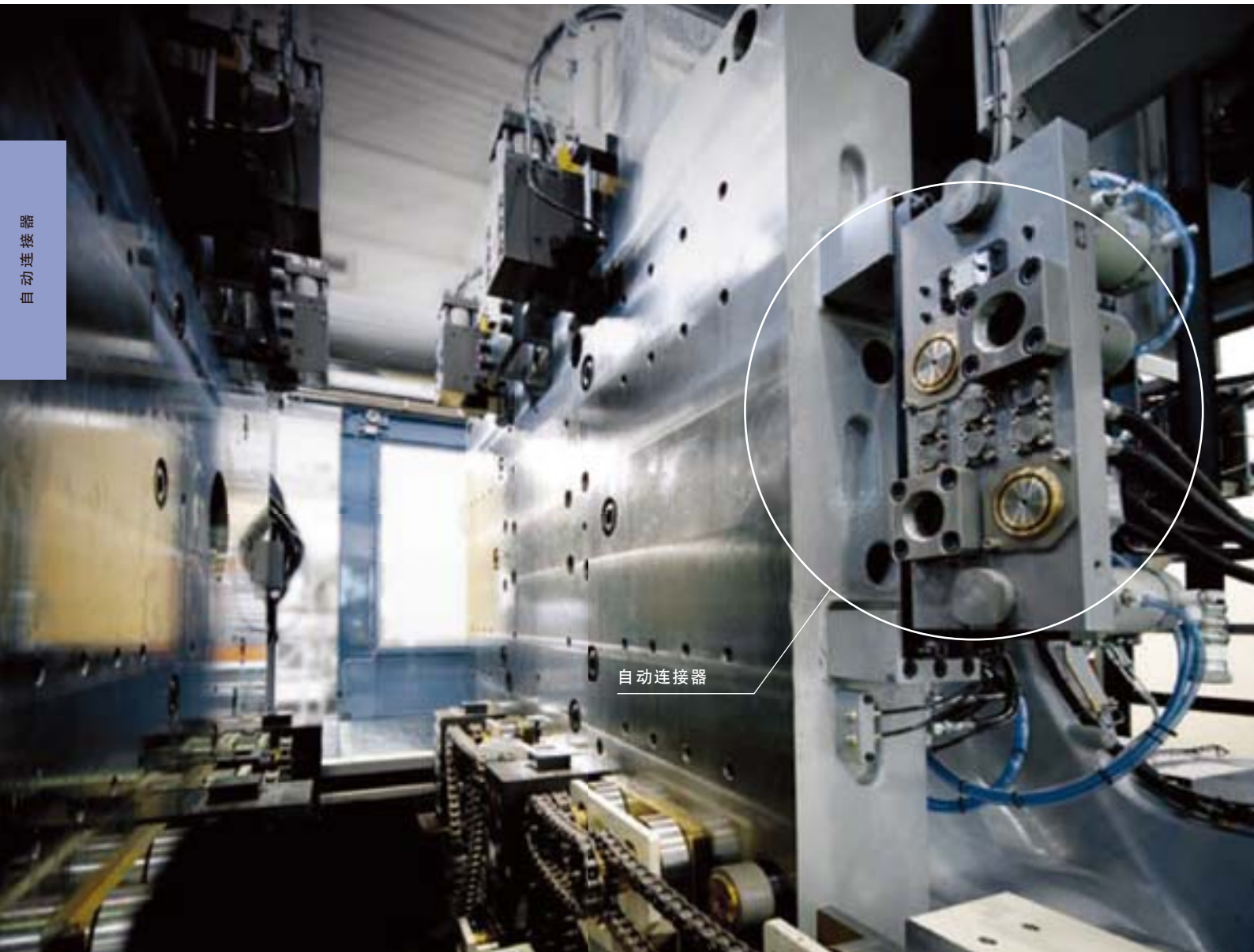
35,000kN(3,500ton)注塑机 横向搬入 自动连接器 & 油压夹紧器 TKC
