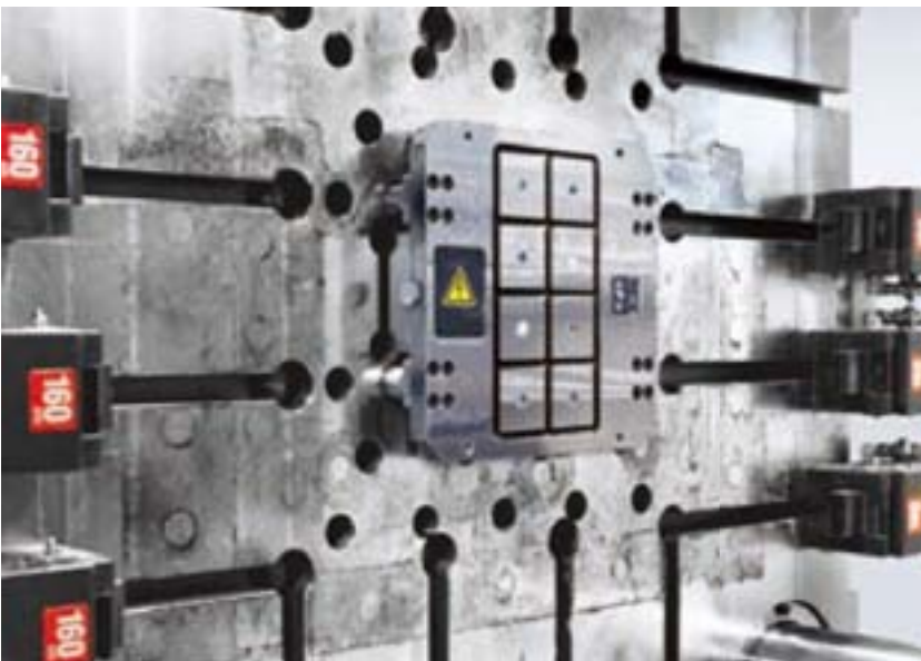
8,500kN (850ton) 压铸机 C板电永磁夹紧器 & 油压夹紧器 TYB
