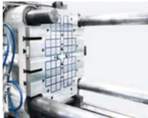
3,500kN (350ton) 压铸机 电永磁夹紧系统 可动侧
