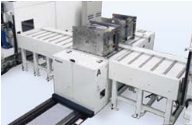
注模更换装置 电动、马达驱动式 装载数量 2模
