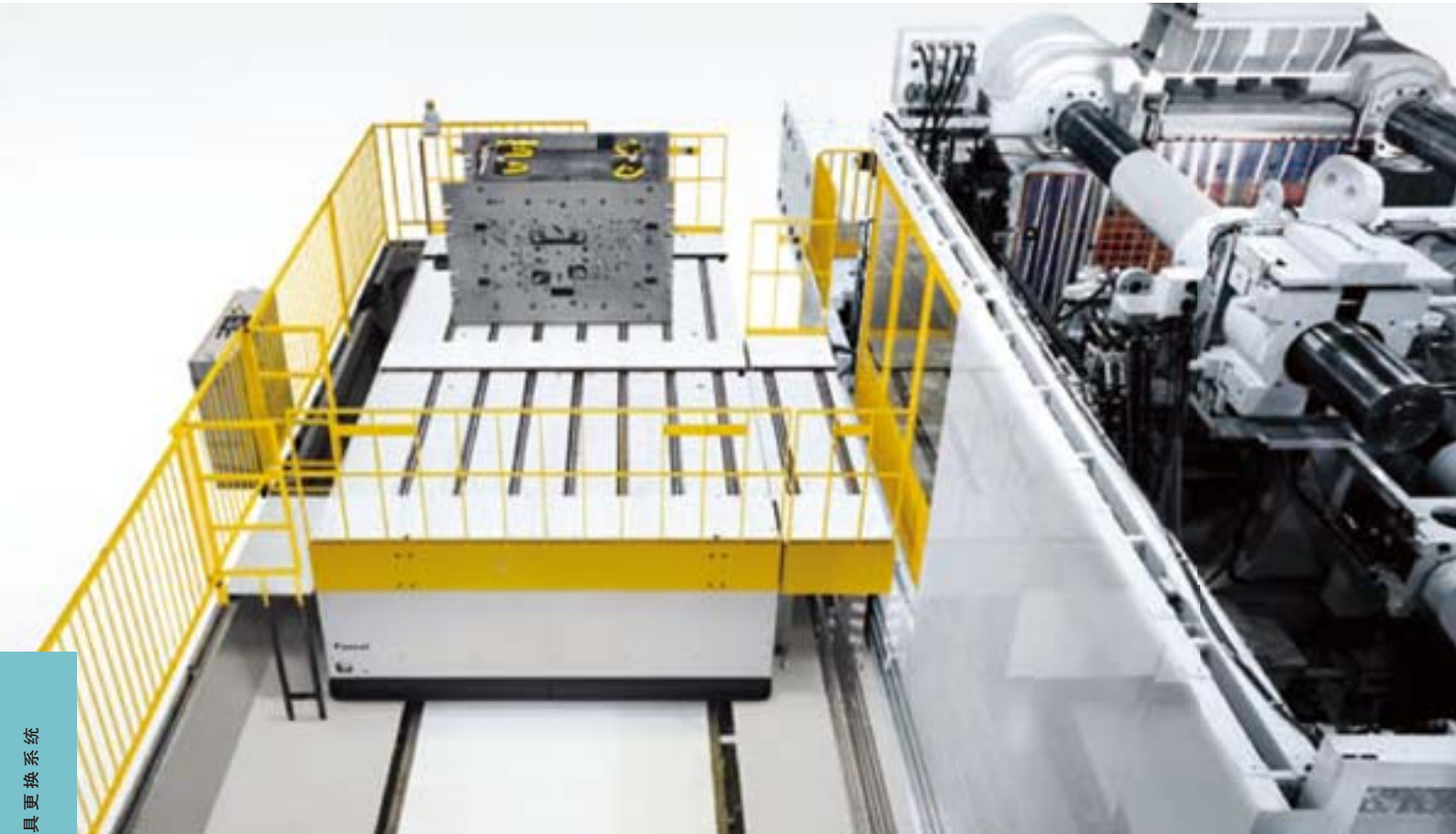
30,000kN (3,000ton) 注塑机 横向搬入 注模更换装置：电动、马达驱动式 装载数量 2模 & 电永磁夹紧系统
