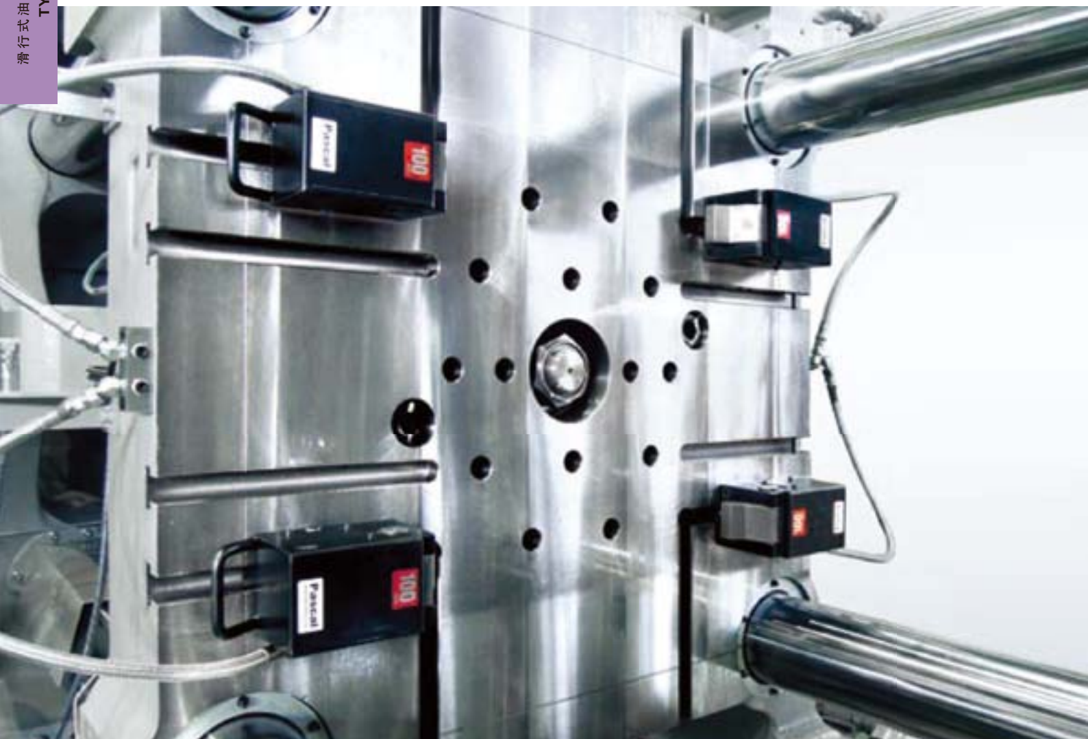
5,000kN (500ton) 压铸机 滑行式油压夹紧器 TYB
