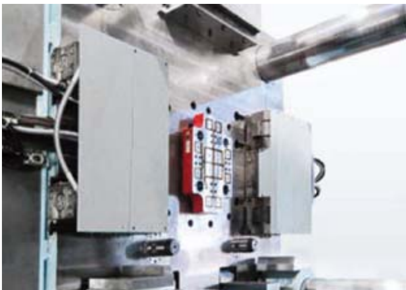
16,500kN(1,650ton)压铸机 C板电永磁夹紧器
