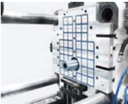
3,500kN (350ton) 压铸机 电永磁夹紧系统 固定侧
