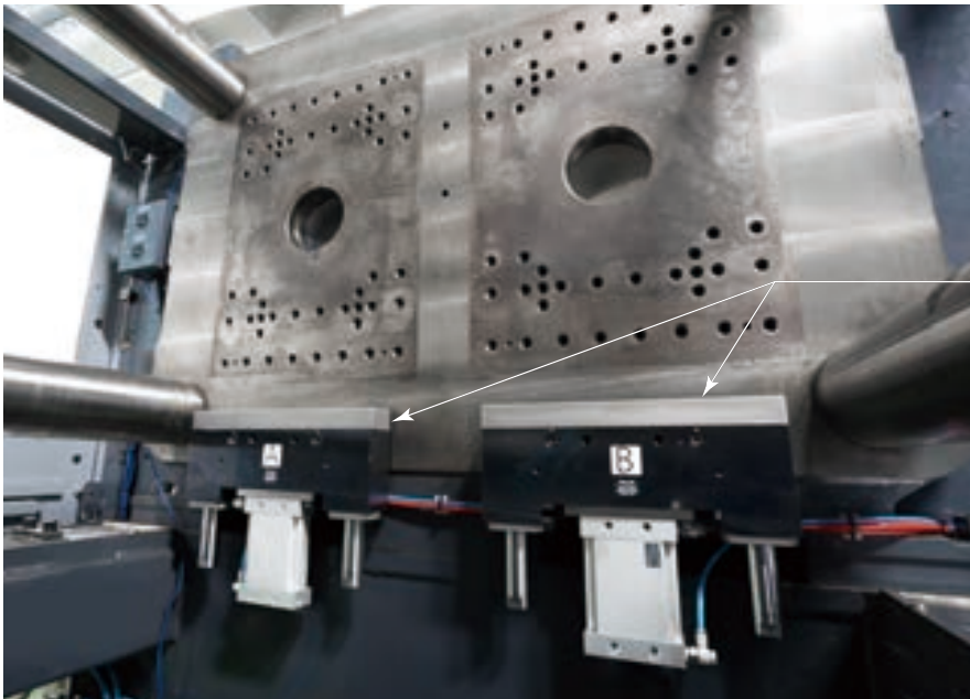
2,800kN (280ton) 2色成形機 ダイレベラー
