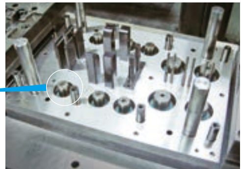
4,000kN (400tonf) 级进冲压 下模 微型 氮气弹簧 采用例
