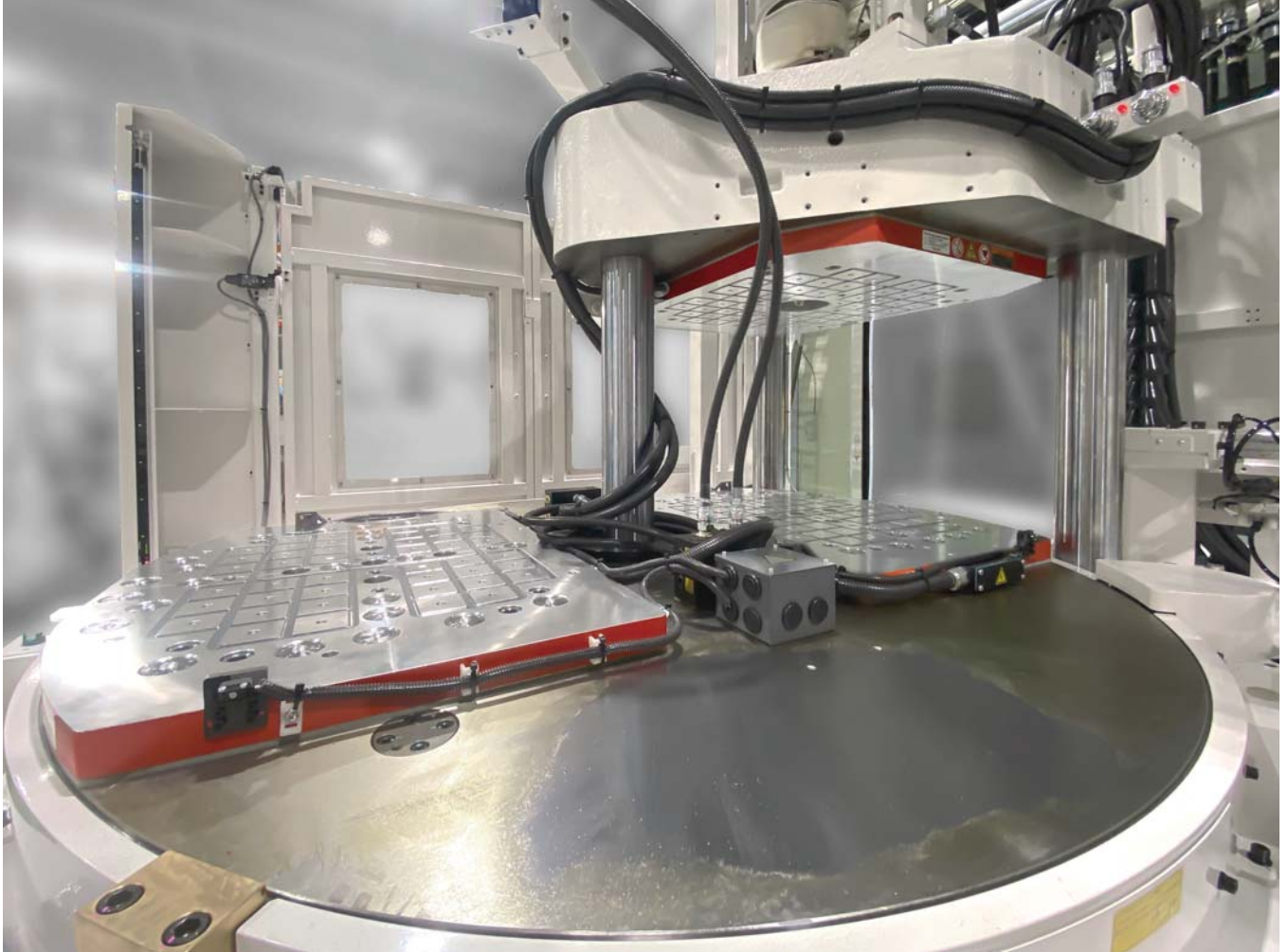
1500kN (150ton) 豎型成形機 (ロータリー) 上型・下型用 薄型マグクランプ (35mm)
