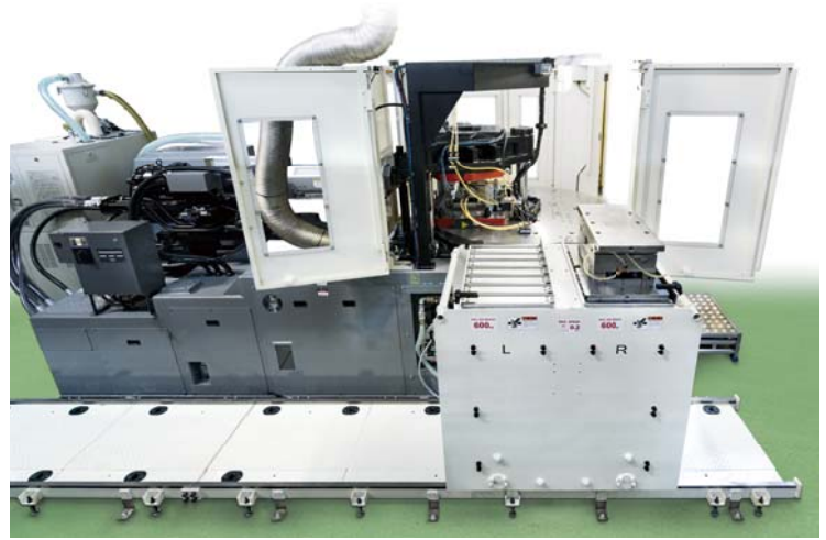
1,000kN 成形機 金型600kg×2型 モールドチェンジャ:マニュアル・レール走行
