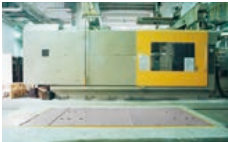
model SMF 埋込設置モデル 床下に埋め込んで設置することができ、反転台上をトラックやフォークリフトが走行できます。
