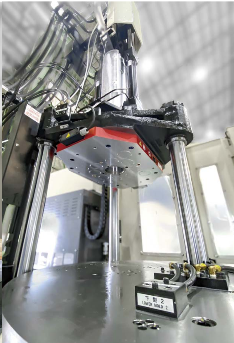
1,000kN (100ton) 竖型成形機 (単動) 上型用マルチマグクランプ
