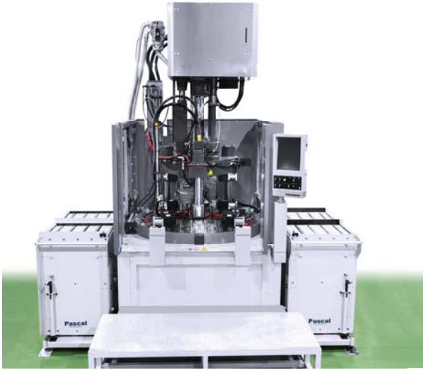
1,500kN 成形機 金型800kg×2型×2台 モールドチェンジャ:マニュアル・レール走行
