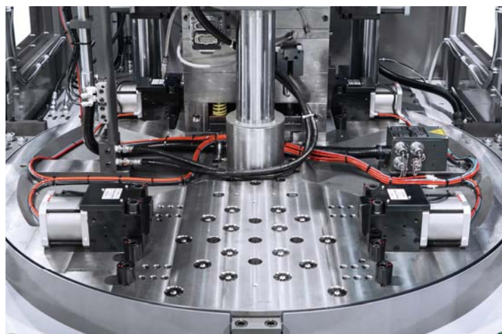
1,500kN 縦型成形機 エアクランプTLA
