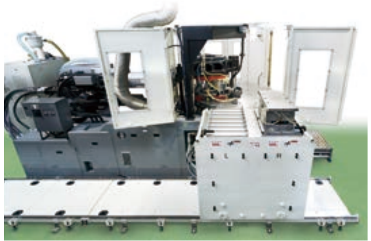
1,000kN 成形機 金型600kg×2型 モールドチェンジャ:マニュアル・レール走行
