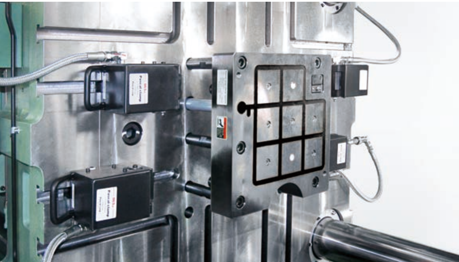
3,500kN(350ton)ダイカストマシン C板マグクランプ & 油圧クランプ TYB
