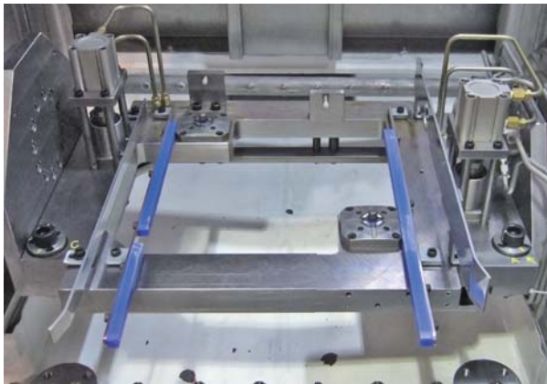
部件清洗夹具 CGX-N22-11×2个 夹孔内经: \varnothing 11 夹紧力: 1.3 kN
