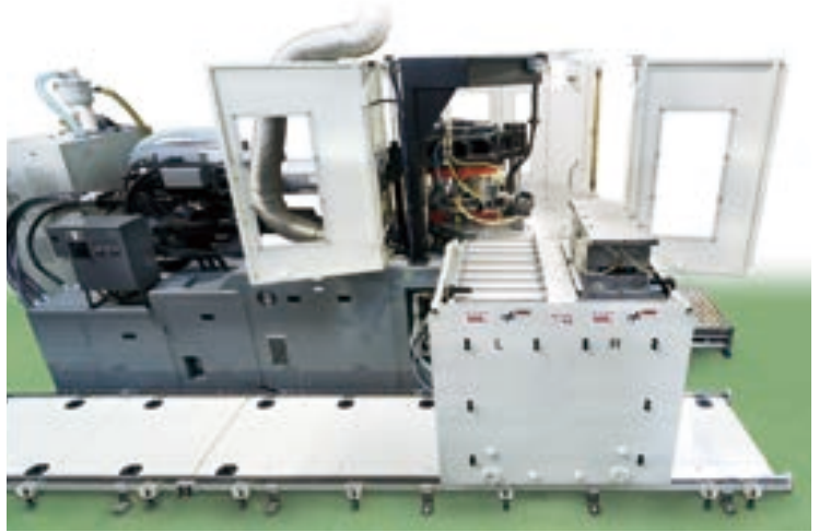
1,000kN 注塑机 模具 600 kg × 2模 注模更换系统: 手动、轨道行走式
