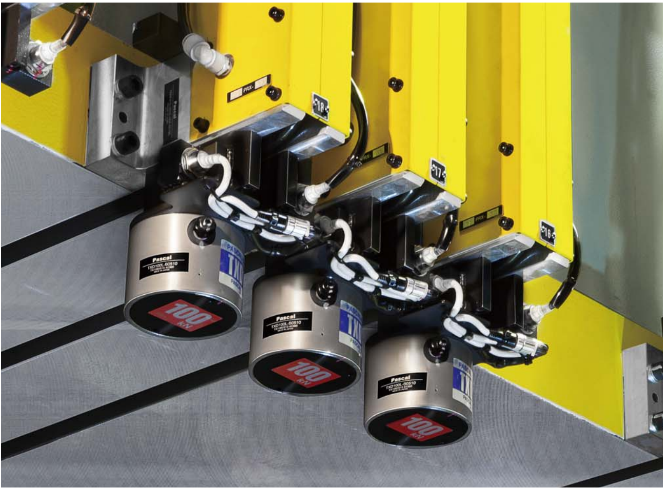
自走式夹紧器 TRA 30,000kN 压力机
