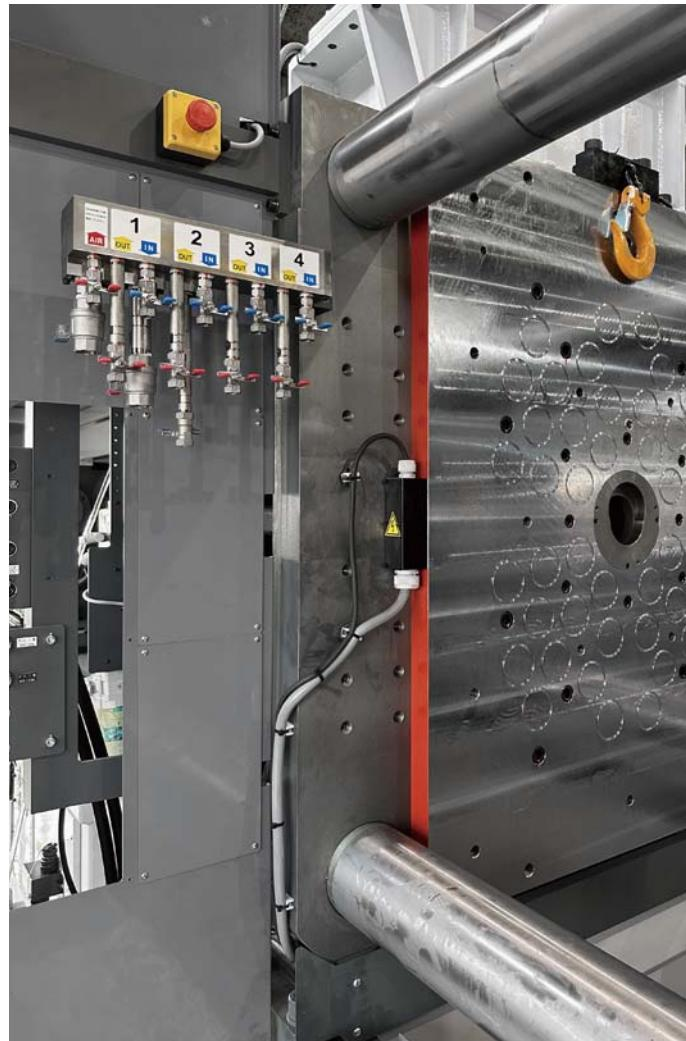
5,500kN (550ton) 注塑机 垂直式分流阀座
