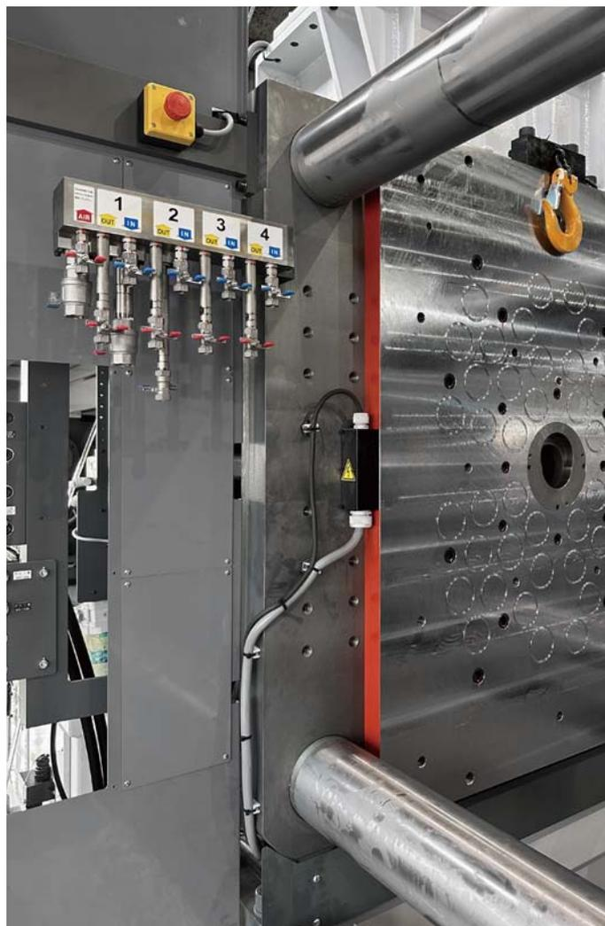
5,500kN (550ton) 注塑机 垂直式分流阀座
