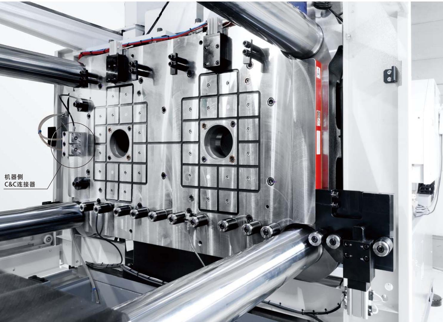
2,500kN (250ton) 双色注塑机 横向搬入式 固定侧电永磁夹紧系统 与 C&C连接器
