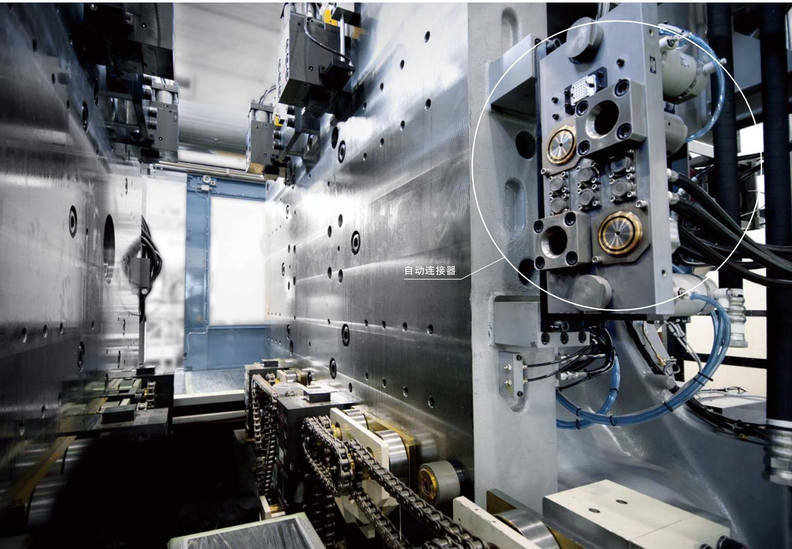
3,5000kN (350ton) 注塑机 横向搬入式 自动连接器及油压夹紧器TKC
