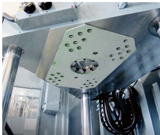
500kN (50ton) 立式注塑机 八角形定位环(上模定位)及万向球轴承
