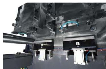
2,800kN (280ton) 双色注塑机 模具调平器
