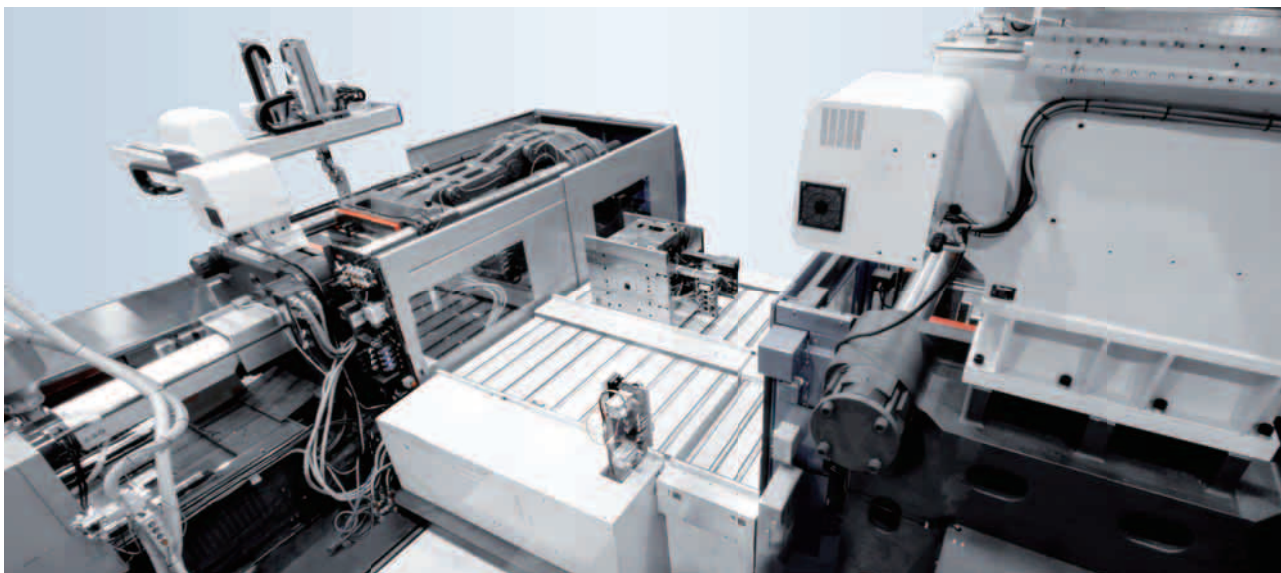
4,500kN (450ton) 注塑机 横向搬入式 换模装置：电动、马达驱动式
