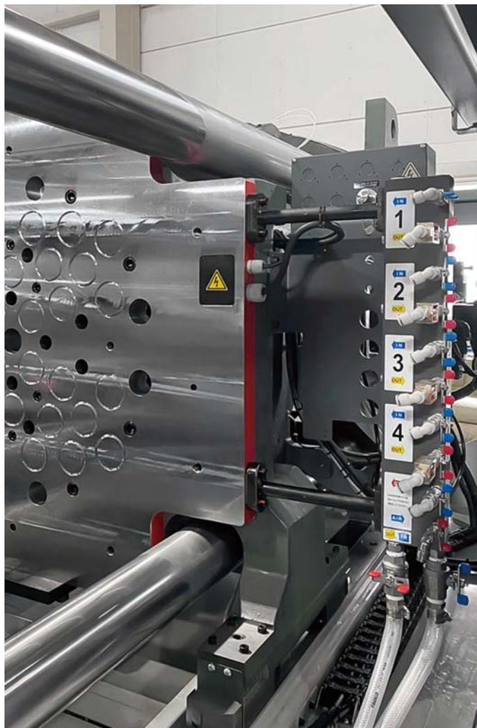
3,500kN (350ton) 注塑机 水平式分流阀座
