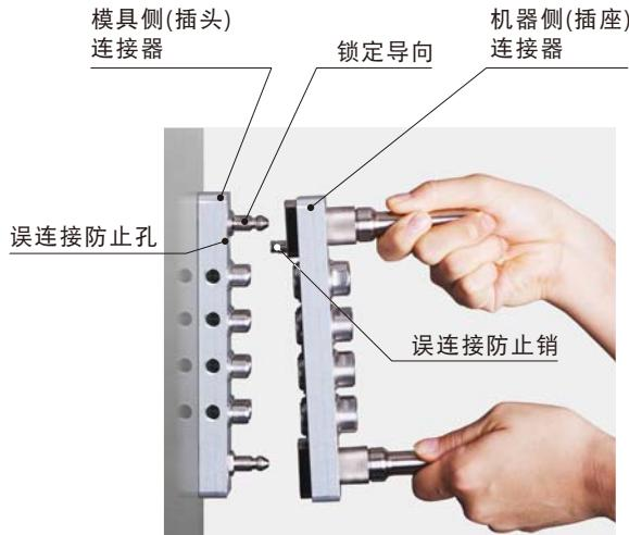
沿着定位导向，插入连接器（凹）
