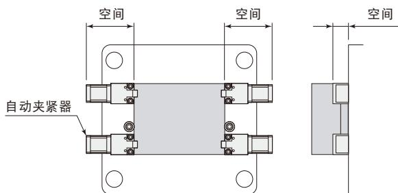
导入电永磁夹紧器，将提高模具设计的自由度
