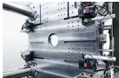
油压 无T形槽 滑行式夹紧器 TYA-M
