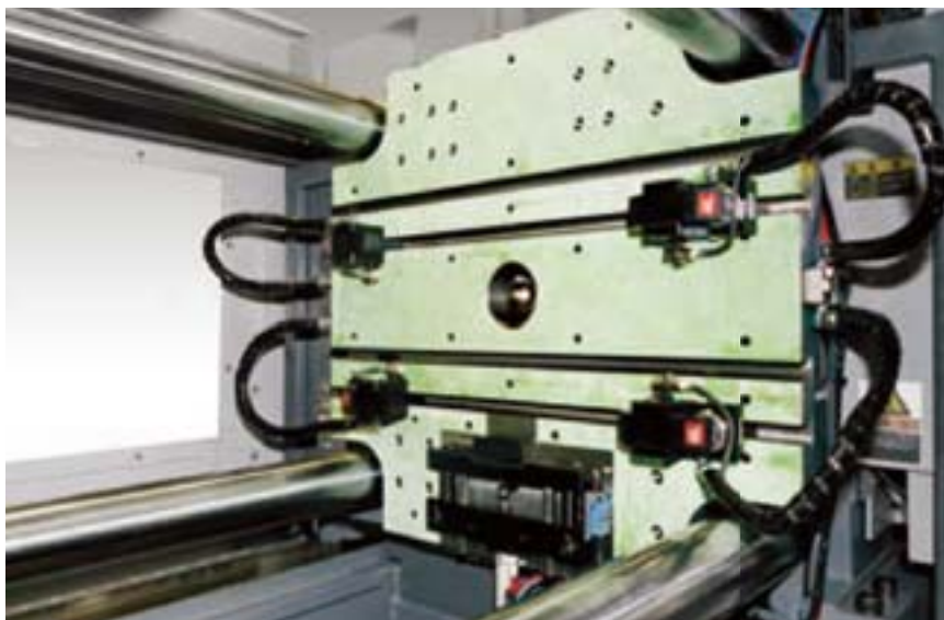
1,800kN (180ton) 注塑机 纵向搬入式 模具定位装置及滑行式油压夹具 TYA040
