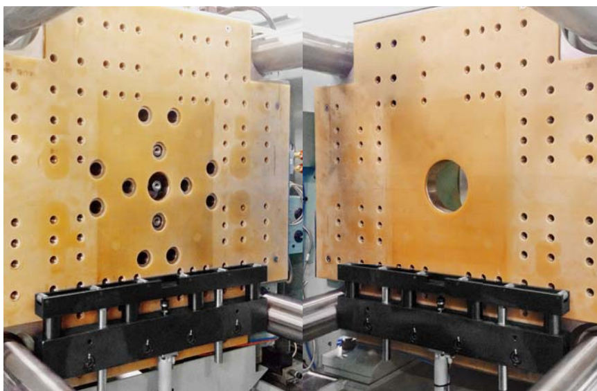
3,500kN (350ton) 注塑机 横向搬入式 模具调位滚轮
