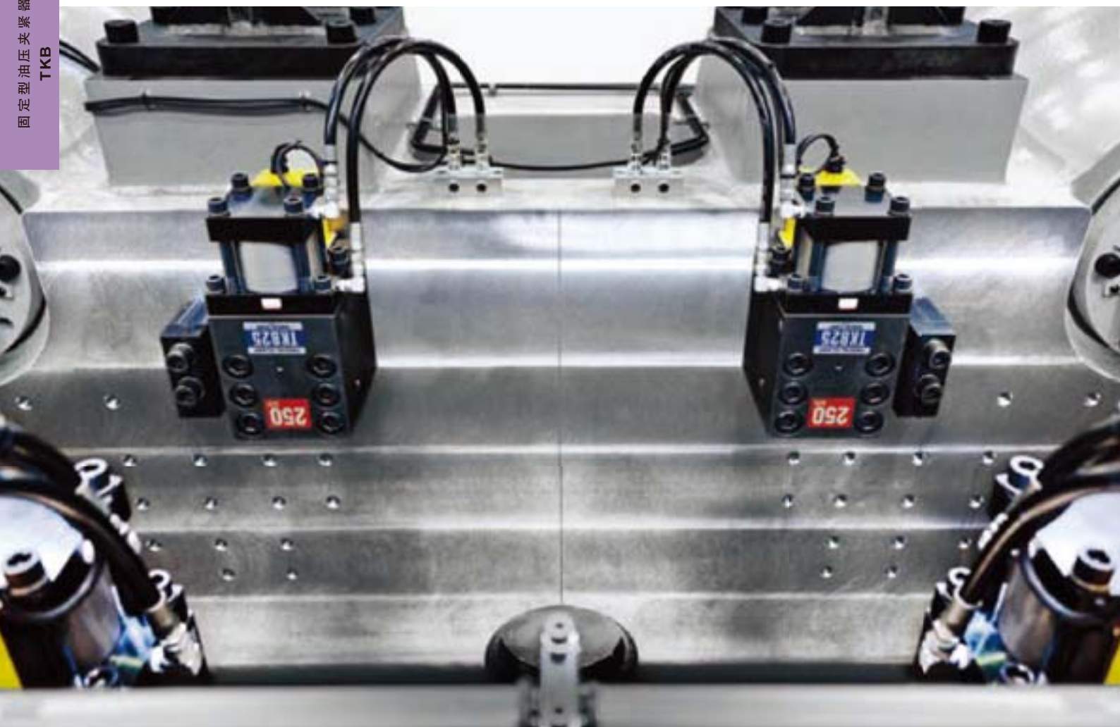
16,000kN(1,600ton) 注塑机 横向搬入式 固定型油压夹紧器 TKB
