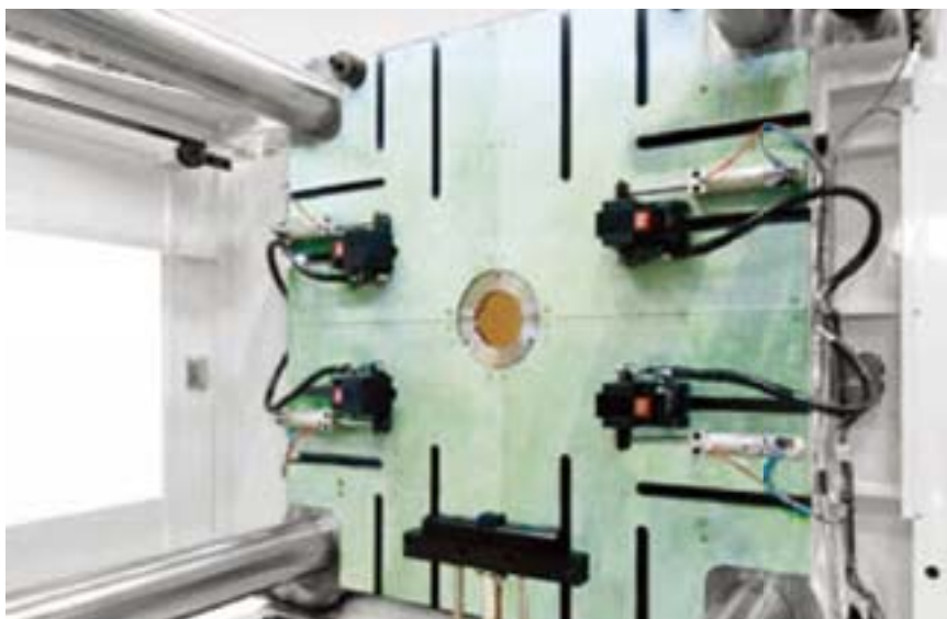
6,500kN (650ton) 注塑机 纵向搬入式 模具定位装置及自动滑行式油压夹具 TYC100Z
