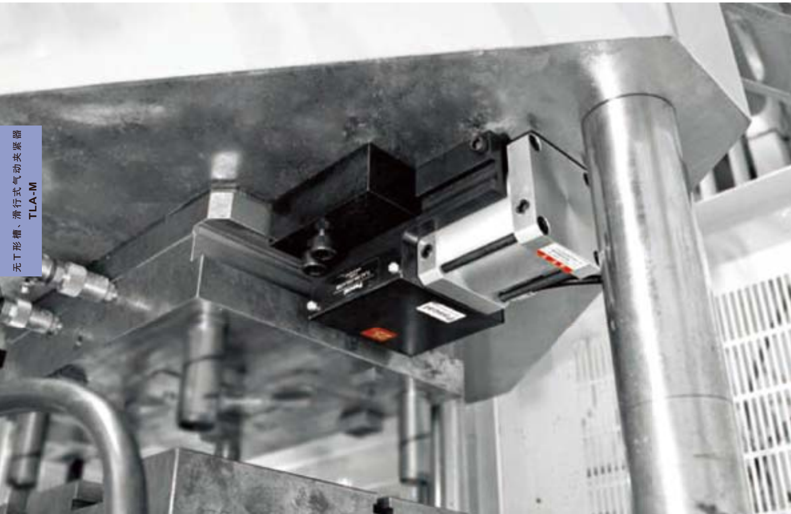
400kN(40ton)立式注塑机 无T形槽、滑行式气动夹紧器 TLA-M
