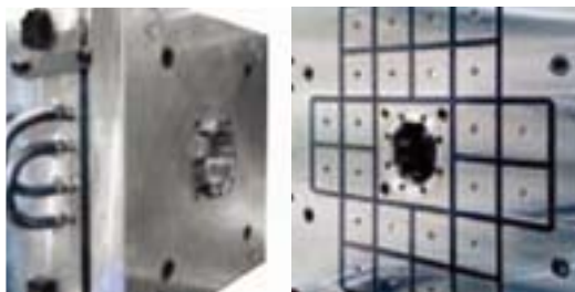
1,800kN (180ton) 注塑机 纵向搬入式 八角形定位环与电永磁夹紧器
