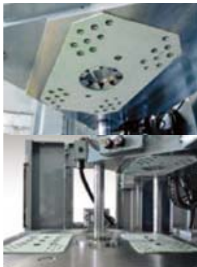
500kN (50ton) 立式注塑机 八角形定位环(上模定位)与万向球轴承
