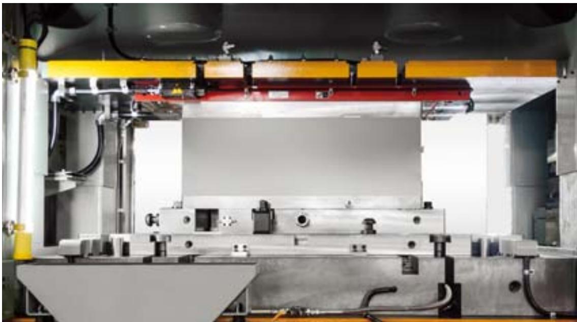
2,000kN (200tonf) 高速压力机 电永磁夹紧系统
