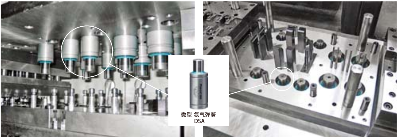
4,000kN (400tonf) 顺送压力机 model DSA 微型氮气弹簧 采用例 (照片左:上模 右:下模)
