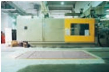
SMF-H型可以嵌入地面下安装， 卡车和叉车可以在翻转台上行驶。
