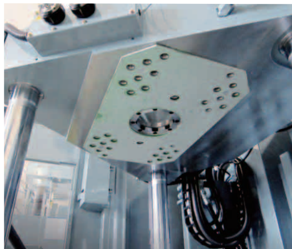
500kN (50ton) 縦型成形機 オクタゴナルロケットリング (上型位置決め) & フリーベア
