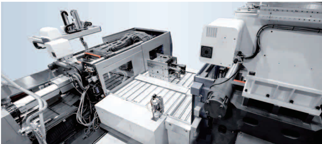
4,500kN (450ton) 成形機 よこ入れ モールドチェンジャ：電動・モータドライブ
