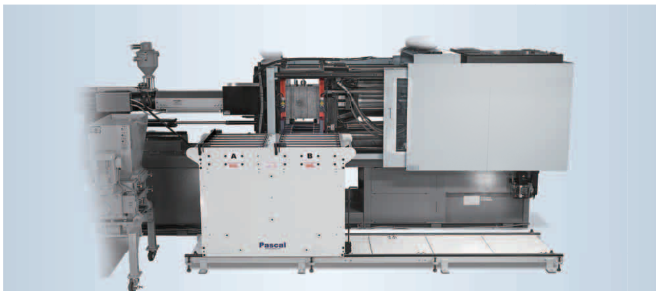
1,750kN (175ton) 成形機 よこ入れ モールドチェンジャ：マニュアル・レール走行式
