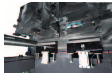
2,800kN (280ton) 2色成形機 ダイレベラー
