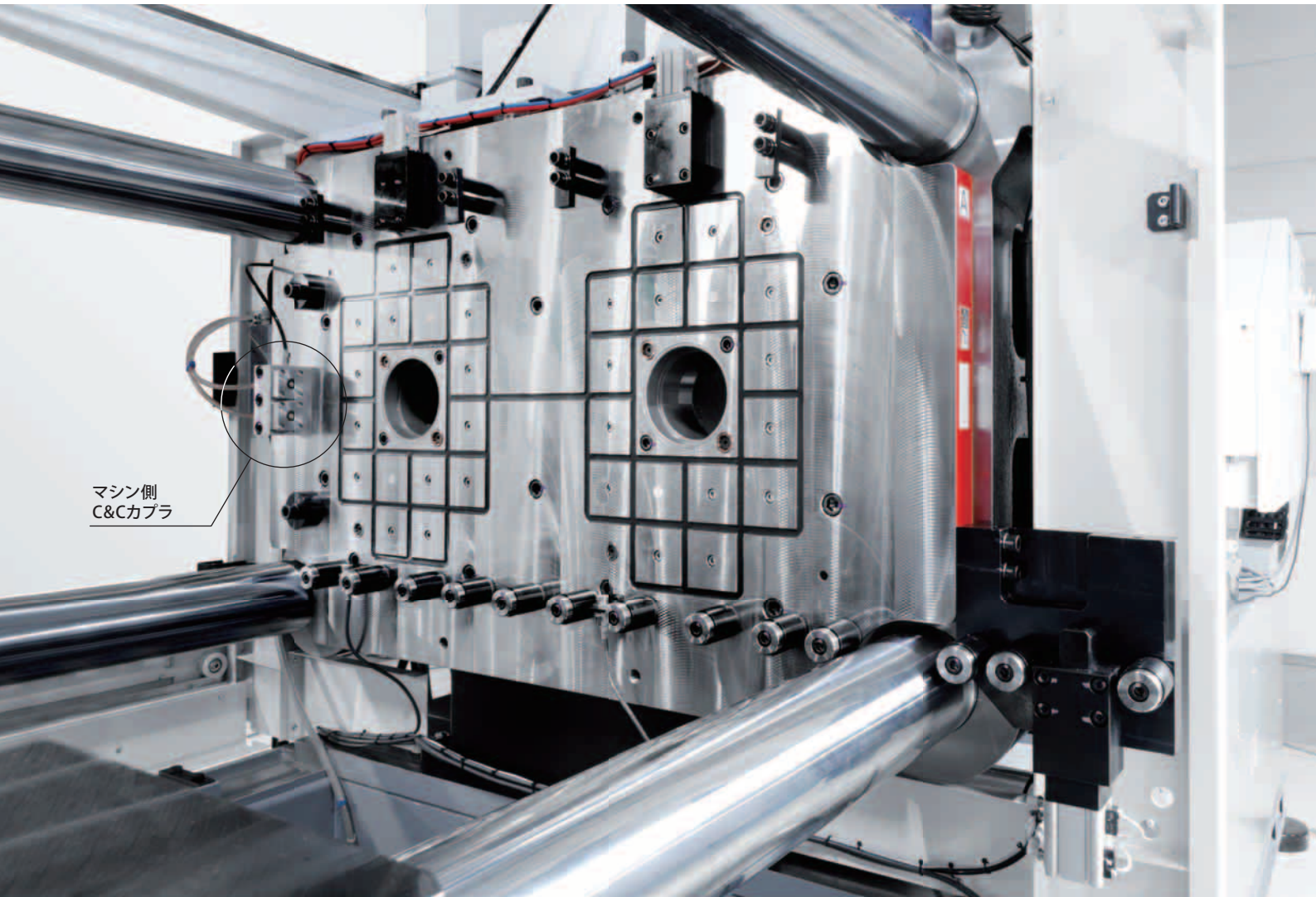
2,500kN (250ton) 2色成形機 よこ入れ マグクランプ & C&Cカブラ
