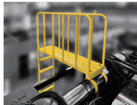
手すり付きの安全な作業スペース
