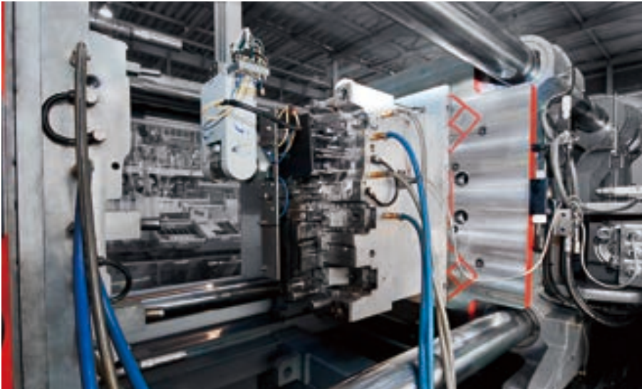
4,500kN (450ton) 成形機 立入れ マグクランプ
