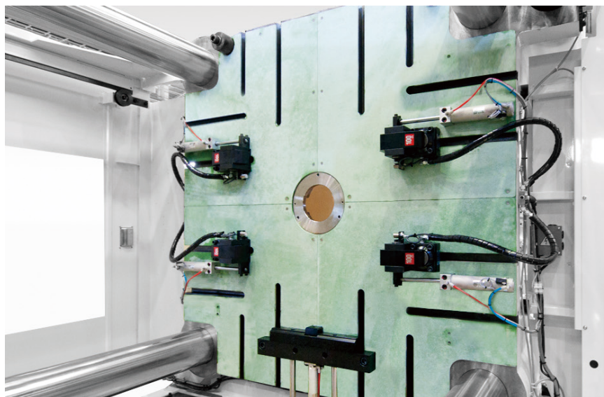
6,500kN (650ton) 成形機 立入れ ダイセッタ & オートスライド 油圧クランプ TYC100Z
