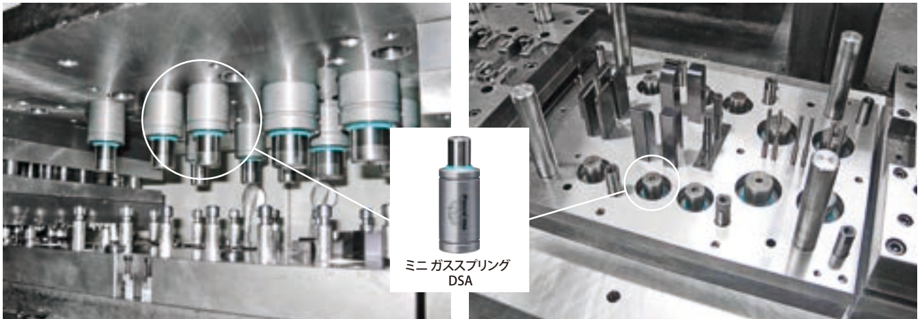
4,000kN (400tonf) 順送プレス ミニガススプリング model DSA 採用例 (写真左:上型 右:下型)
