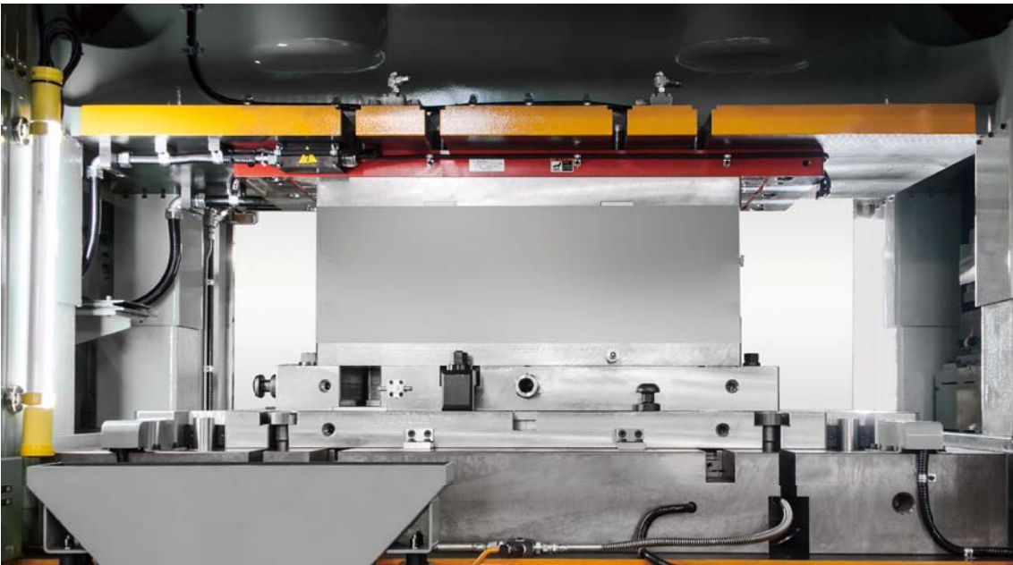
2,000kN (200tonf) 高速プレス プレスマグクランプ
