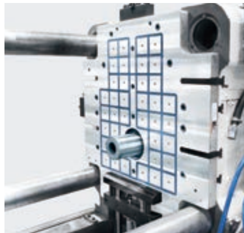
3,500kN (350ton) ダイカストマシン マグクランプ 固定側
