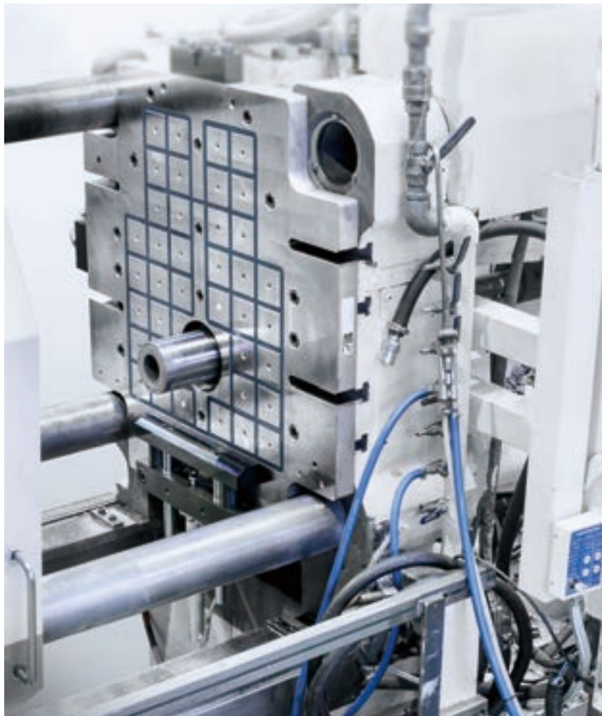
3,500kN (350ton) ダイカストマシン マグクランプ & ダイセッタ
