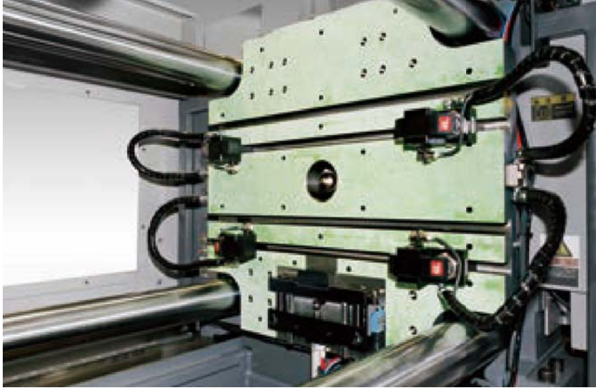
1,800kN (180ton) 成形機 立入れ ダイセッタ & スライド 油圧クランプ TYA040
