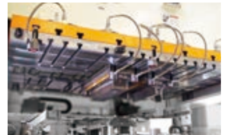
4,000kN (400tonf) トランスファープレス プレスマグクランプ & TXA
