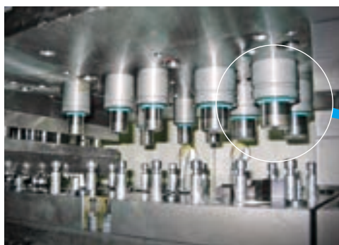
4,000kN (400tonf) 順送プレス 上型 ミニN2ガススプリング 採用例
