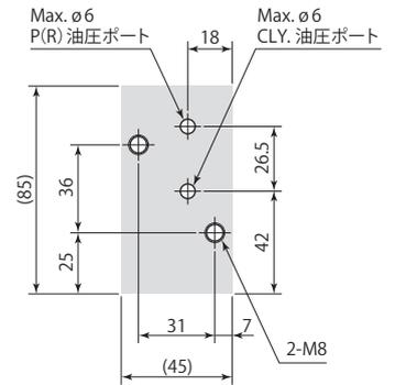
ガスケット配管のため、取付面は最大高さ粗さRz6.3以下に仕上げてください。
