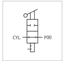
同一回路中のクランプを個別に作動させることができます。
