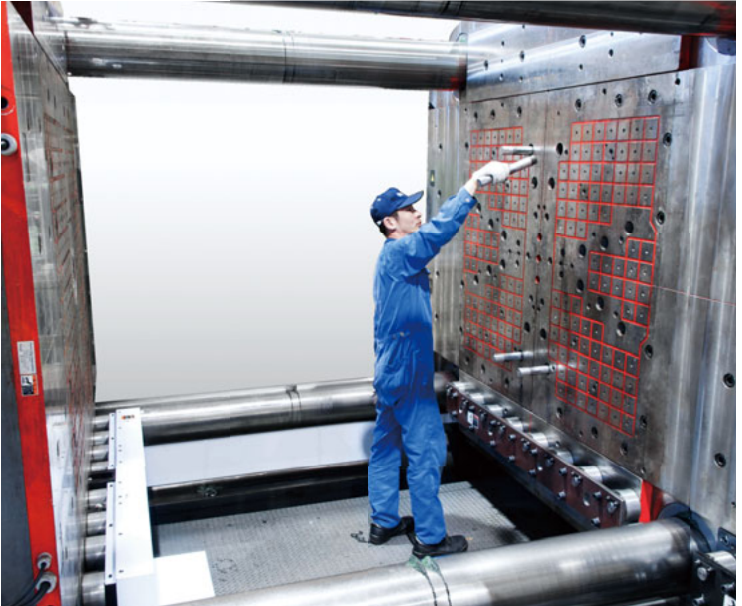
18,000kN (1,800ton) 注塑机 横向搬入式 电永磁夹紧系统 & 快捷推顶杆
