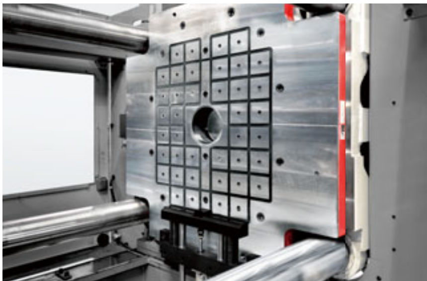
3,500kN (350ton) 注塑机 纵向搬入式 模具定位装置及电永磁夹紧器
