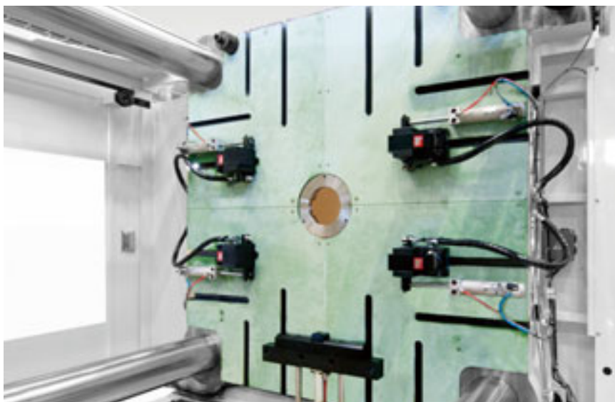
6,500kN (650ton) 注塑机 纵向搬入式 模具定位装置及自动滑行动式油压夹紧器 TYC100Z
