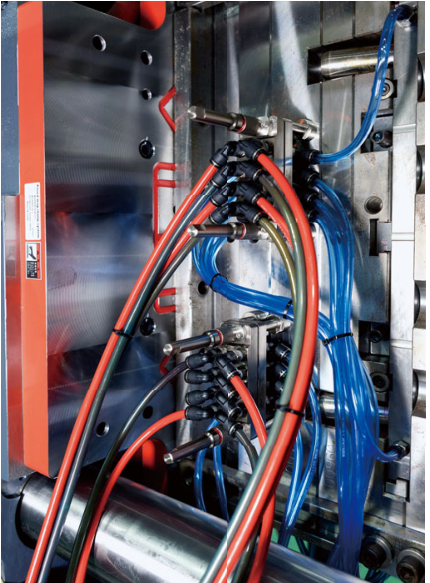
2,800kN(280ton) 注塑机 纵向搬入式 电永磁夹紧系统 & 开放型多用连接器
